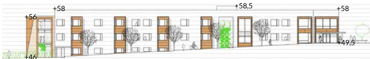
Fasad mot lokalgatan i öster med de olika höjderna i meter över nollplanet angivna
