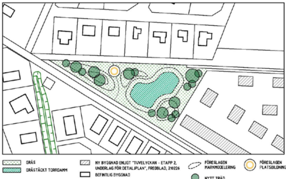
Fördröjningsmagasin (torrdamm) i nordväst (Bild: Afry, 2021-12-13)
