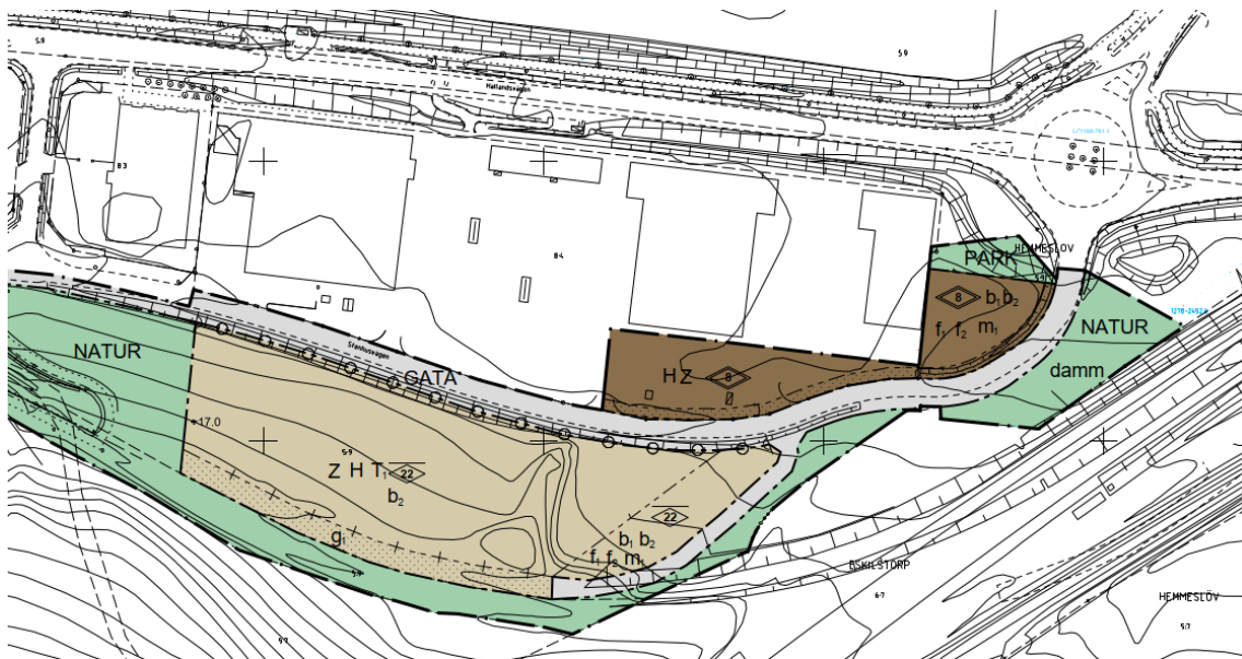
Figur 4 Planområdet (del av plankarta). Verksamhetstyp T_1 har utgått sedan plankartan togs fram, och är inte längre aktuell. E_1 för teknisk anläggning kan komma att tillkomma.
