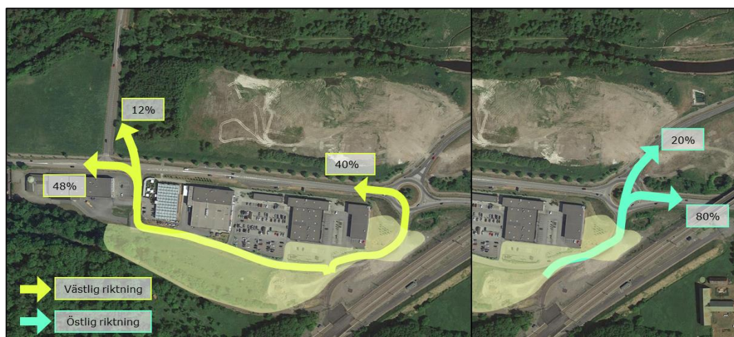
Figur 6: Fördelning av alstrad trafik till följd av exploatering av planområdet. Samma fördelning antas för både resor till och från planområdet.
