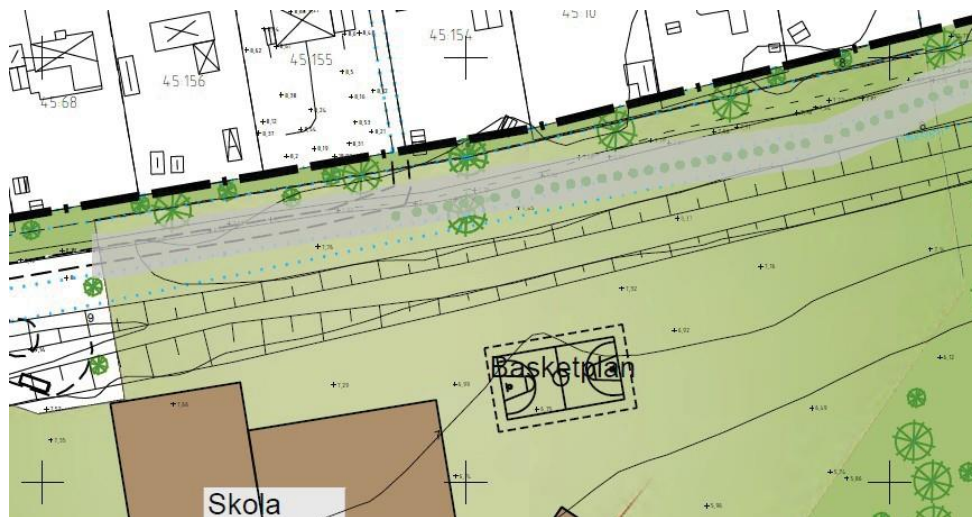
Figur 1. Med illustrationskartan som grund markerar transparent grå linje ge-väg som planerats inom den u-markerade kvartersmarken.
